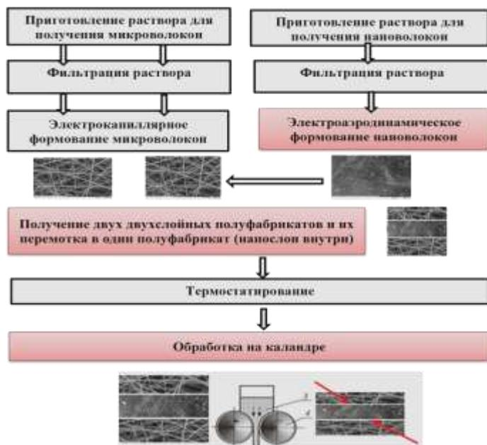
Рисунок 11– Блок–схема производства сепарационных материалов комбинированным методом с последующей постобработкой методом каландрования
